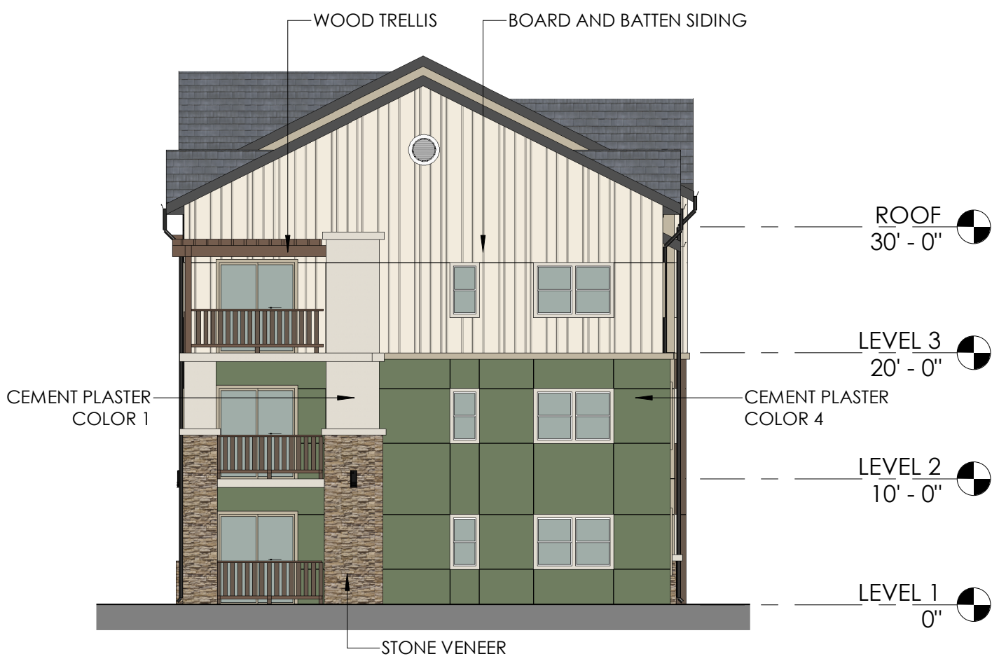
BLDG B - ELEVATION
