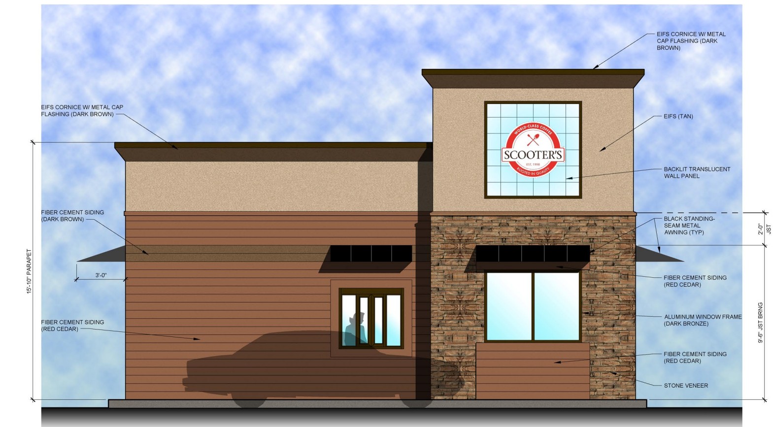
A1 EXTERIOR ELEVATION SCALE: 3/8" = 1'-0"
